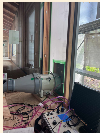
▲気密測定 気密が認定基準内であるかどうかを確認
